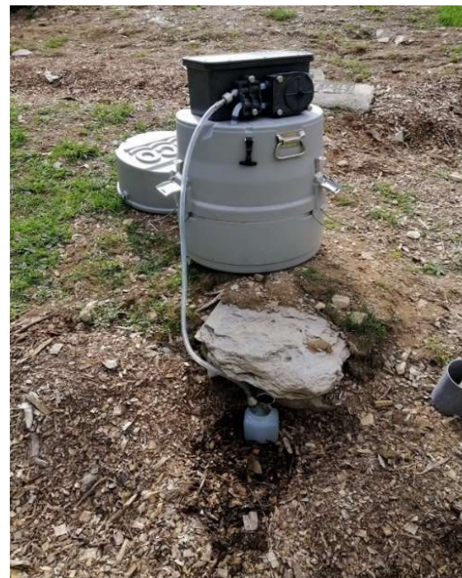
Equipement du point de prélèvement en sortie du filtre vertical à l'arrivée sur le FBB étanché
