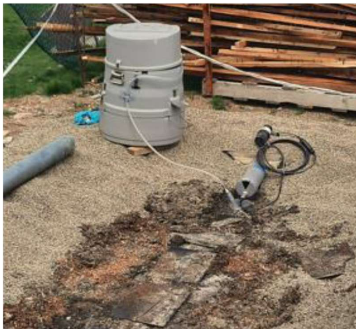
Manchon déversoir et débitmètre (pression) sur canalisation d'arrivée sur le filtre vertical
