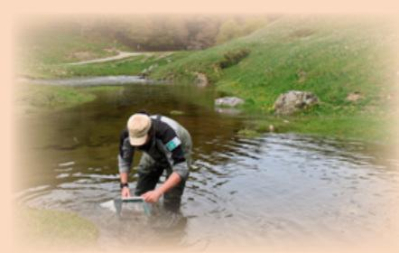
Un filet placé au fond du lit, appelé «filet Surber», permet de récolter les macro invertébrés des cours d'eau échantillonnés
